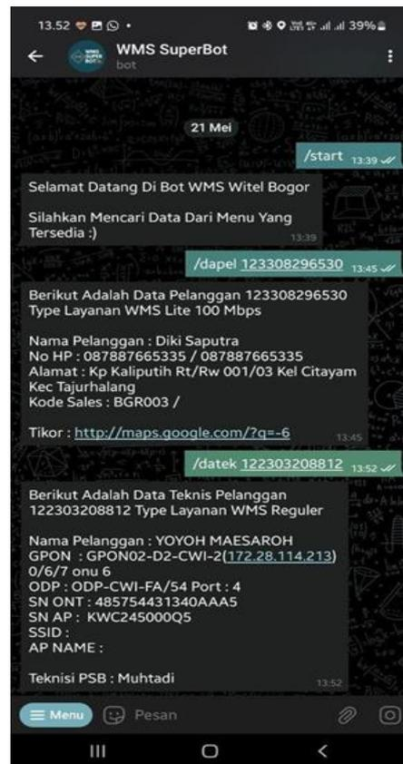
Gambar 7. Test Function /datek yang berisi, port OLT, Serial Number perangkat di lokasi, SSID dan juga nama teknisi yang progres pasang baru
