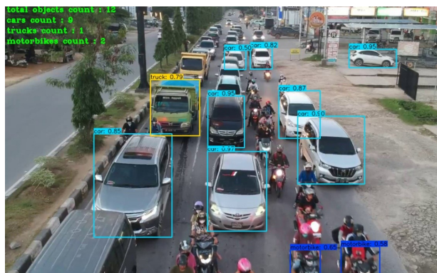
Gambar 4.2. Hasil Pengujian Kalkulasi Kendaraan Yang Tertangkap Kamera Drone
